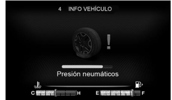
El sistema iTPMS avisa al conductor sobre la eventual presencia de una condición de presión de llenado diferente de la condición en el momento de la puesta a cero, si esa presión baja a un valor inferior al límite de advertencia por cualquier motivo, incluyendo los efectos de la baja temperatura y la normal pérdida de presión del neumático.
