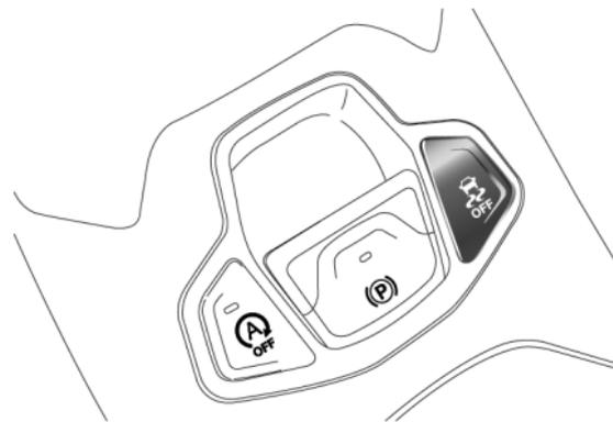
La activación del modo se indica con el encendido del testigo
