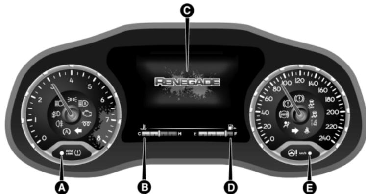
A- Tacómetro B- Indicador digital de temperatura del líquido de refrigeración del motor C- Pantalla multifunción D- Indicador digital del nivel de combustible (el triángulo
