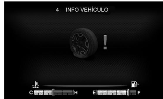
**IMPORTANTE:** el conductor no debe realizar la puesta a cero en el caso descrito anteriormente. En cuanto el sistema vuelva a recibir señales precisas de la condición de llenado de los neumáticos, el testigo se apagará y el sistema volverá a funcionar normalmente.
