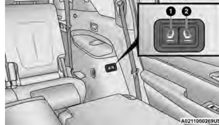
Interruptores de plegue eléctrico del pilar C (se muestra el lado izquierdo)
