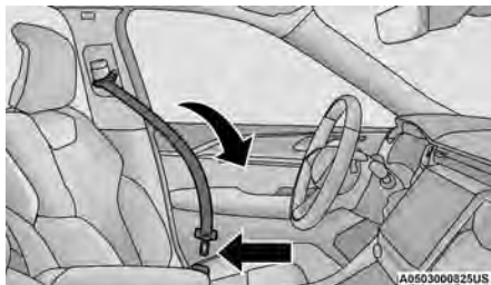
Extracción de la placa de cierre
