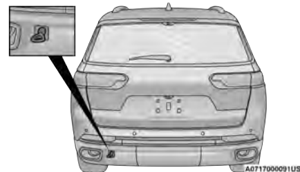
Anilla para remolque trasera instalada
