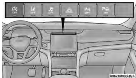
Interruptor OFF (Apagado) del sistema de Detención/Arranque
