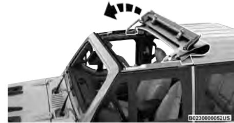
Presionar hacia delante la capota Sunrider®
