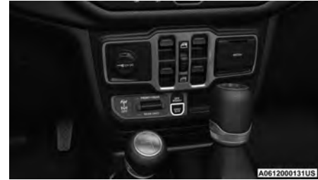
Interruptor de la BARRA ESTABILIZADORA
