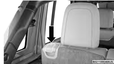
Palanca de liberación del respaldo del asiento
