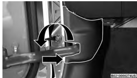
Puerta de acceso al cableado
