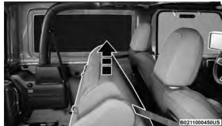
Correa de retención en la posición abatida del asiento trasero
