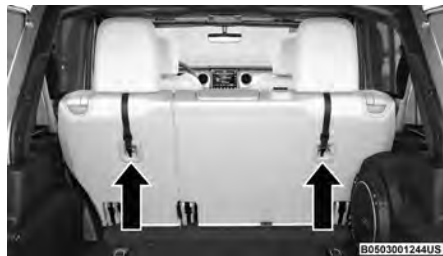
Anclajes de la correa de atadura (modelos de cuatro puertas)
