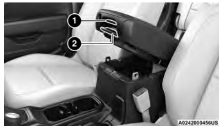
Pestillos del almacenamiento de la consola
