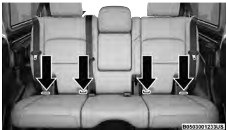
Anclajes ISOFIX (modelos de cuatro puertas)
