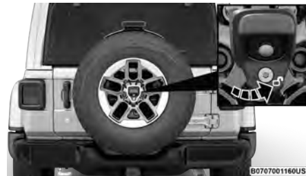
Desbloquear la cubierta de la cámara trasera
