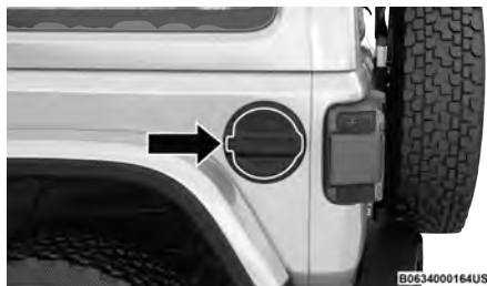
Compuerta de llenado de combustible
