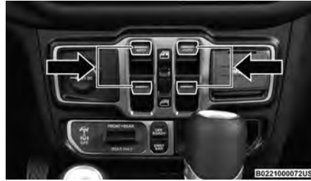
Interruptores de las ventanas eléctricas
