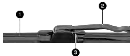
Plumilla del limpiador con pestaña de liberación en posición bloqueada
