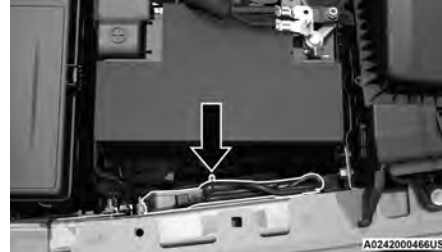
Conexiones del interruptor auxiliar - Debajo del capó
