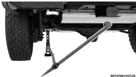
Posición trasera de elevación con gato
