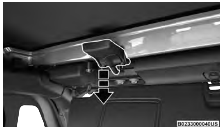
Liberar ambos pestillos del cabezal
