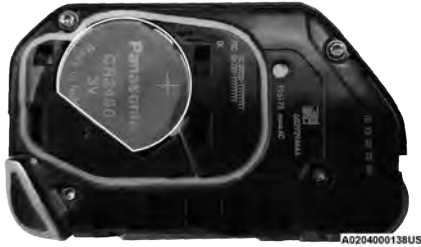
Sustitución de pilas
