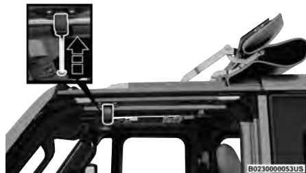
Fijar el perno del riel de la puerta delantera
