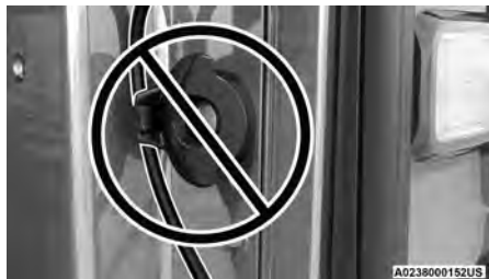
Correa de la compuerta trasera incorrectamente asentada
