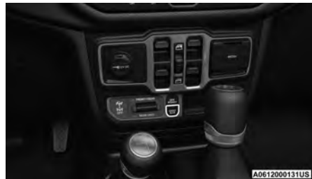
Interruptor de la BARRA ESTABILIZADORA
