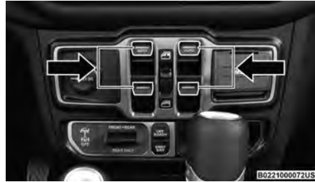
Interruptores de las ventanas eléctricas
