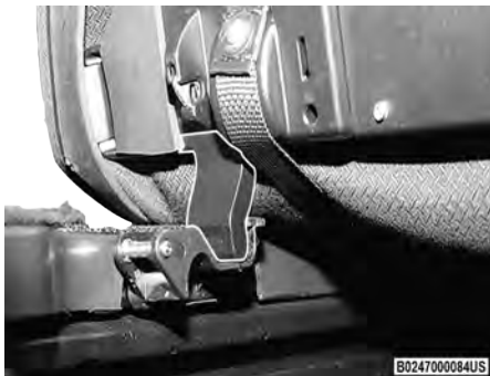
Retenedor colocado correctamente
