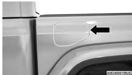
Compuerta de llenado de combustible
