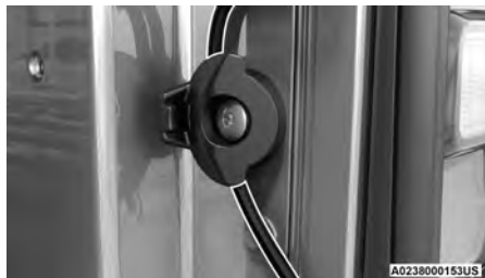
Correa de la compuerta trasera correctamente asentada
