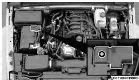
Borne positivo (+) de la batería – Motor de gasolina
