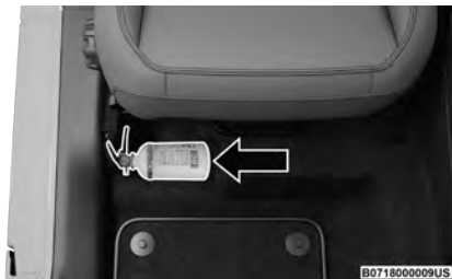
Ejemplo de ubicación del extintor de incendios
