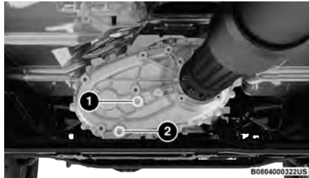
Caja de transferencia
