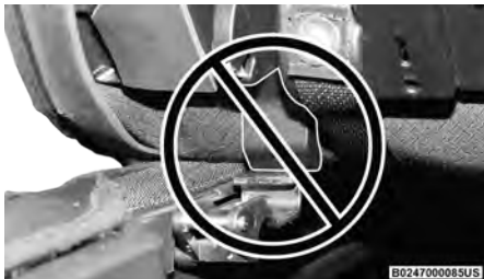
Retenedor colocado incorrectamente
